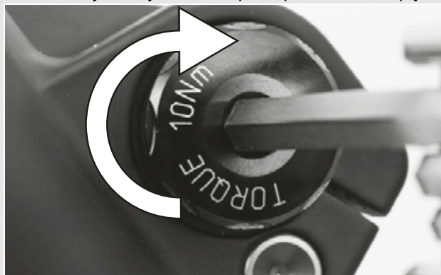
Rysunek 17: Sposób dokręcania włożonej osi
