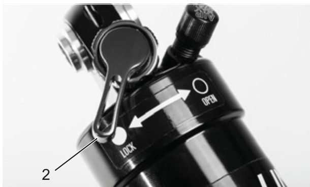
Rysunek 57: Zamknięty nastawnik dobicia Suntour (2)
