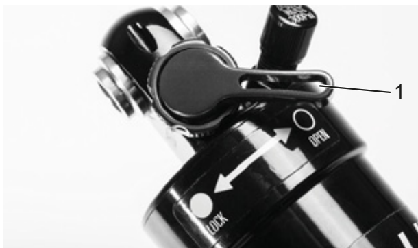
Rysunek 56: Otwarty nastawnik dobicia Suntour (1)
