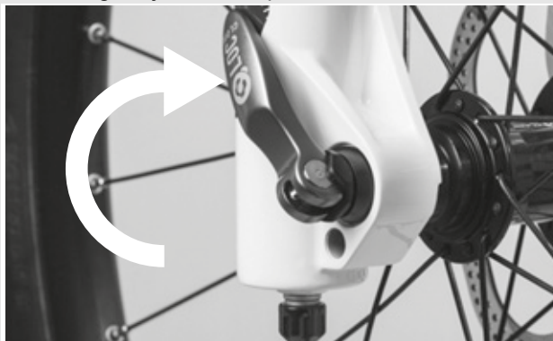
Rysunek 28: Zamykanie zacisku szybko mocującego
