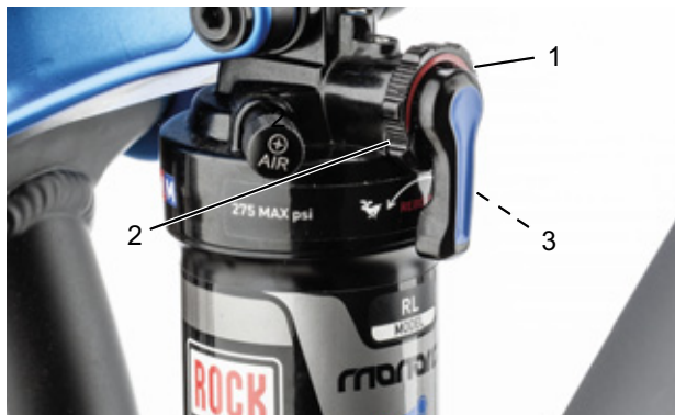
Rysunek 61: Ustawianie twardości tłumika odbicia za pomocą pokrętła regulacyjnego (1)
