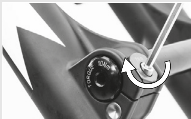
Rysunek 18: Sposób dokręcania zacisku zabezpieczającego
