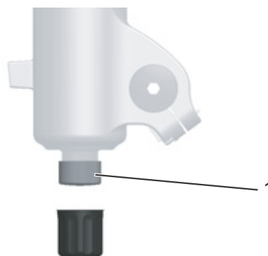
Rysunek 48: Nastawnik odbicia FOX (1) na zabezpieczeniu widelca przed wypadnięciem
