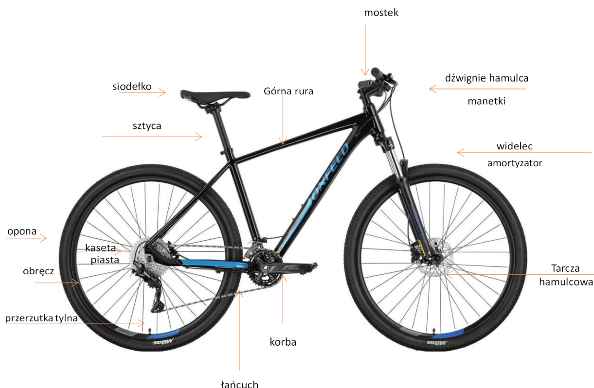
Schemat przedstawiający najważniejsze elementy budowy roweru.
