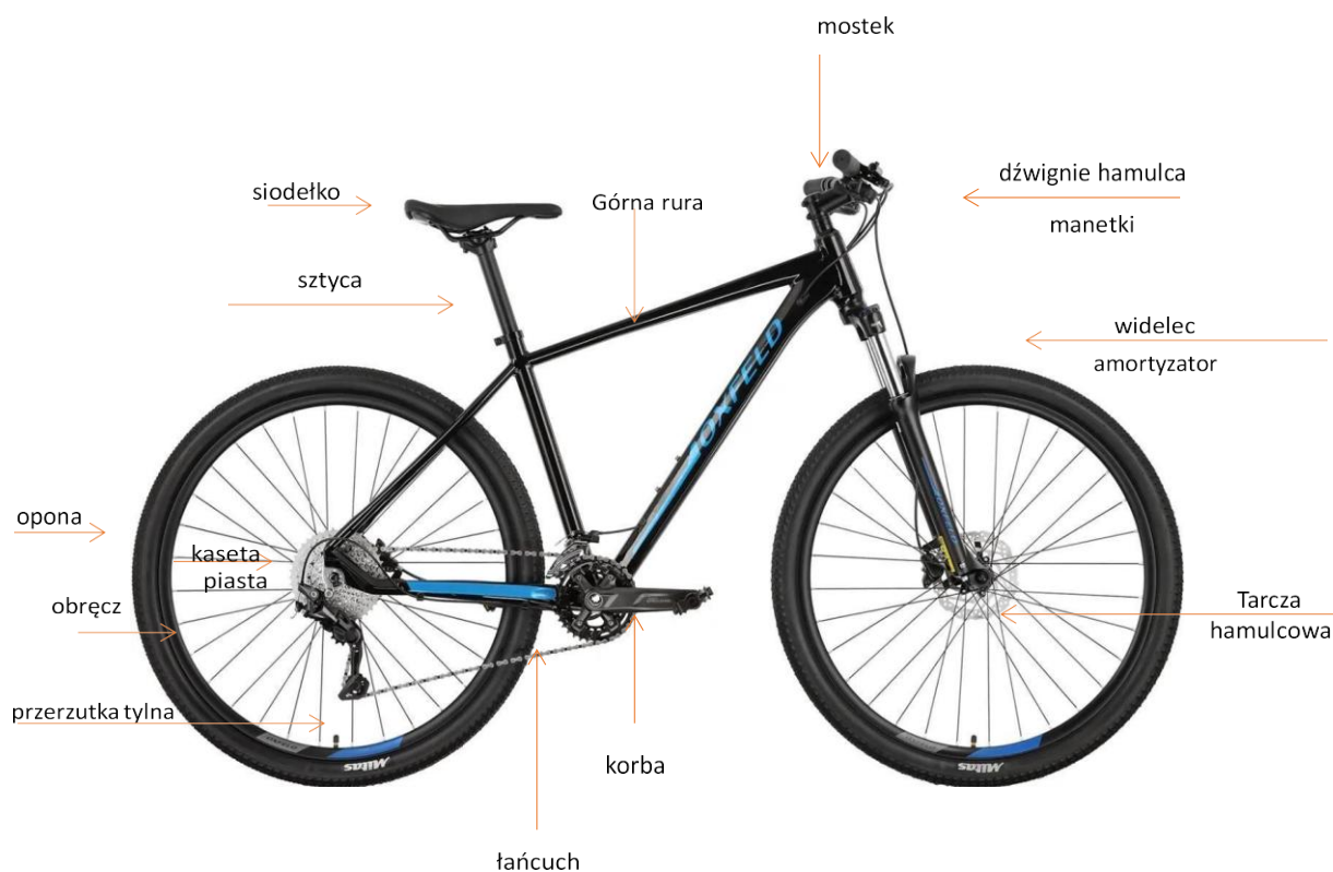
Schemat przedstawiający najważniejsze elementy budowy roweru.
