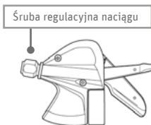
Rys. 61 Regulacja naciągu linki ©Shimano
