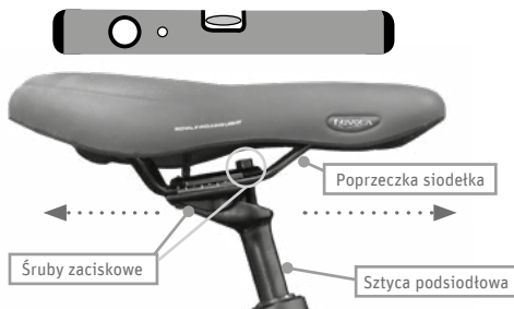
Rys. 24a Regulacja pozycji siodełka
