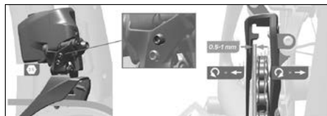
Rys. 96 Ustawianie górnego ogranicznika ©Sram
