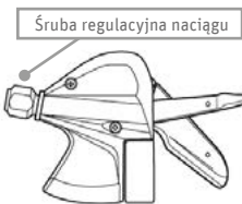
Rys. 83 Regulacja naciągu linki ©Shimano
