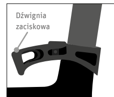
Rys. 19a Dźwignia zaciskowa otwarta
