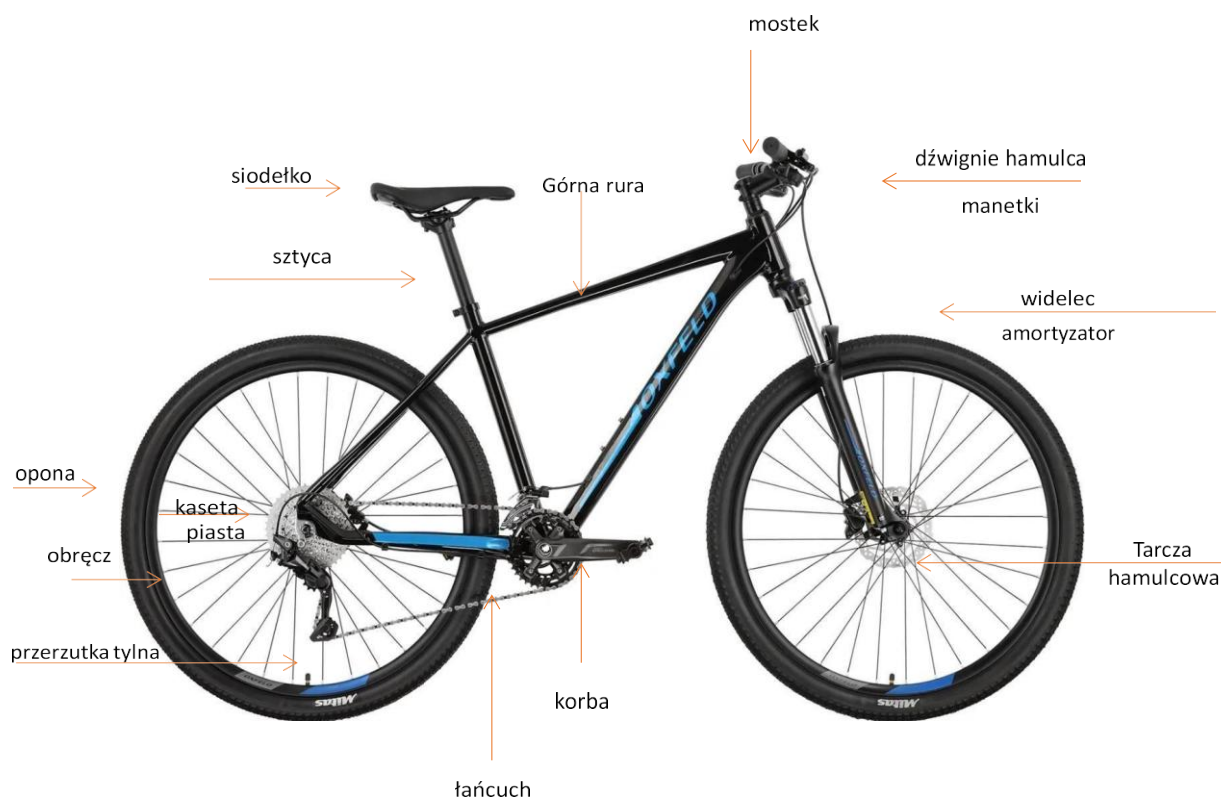
Schemat przedstawiający najważniejsze elementy budowy roweru.
